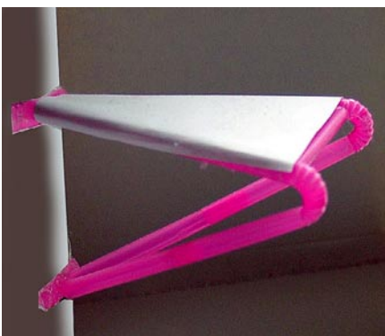
Mitt slutgiltiga val, med två vinklade rörbockar. Därmed kan den perforerade plåtsitsen smita om bockarna och det sammanbindande främre stagen.
