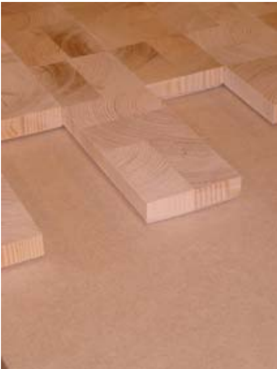
Bord under Bygge, med elastiskt lim.
