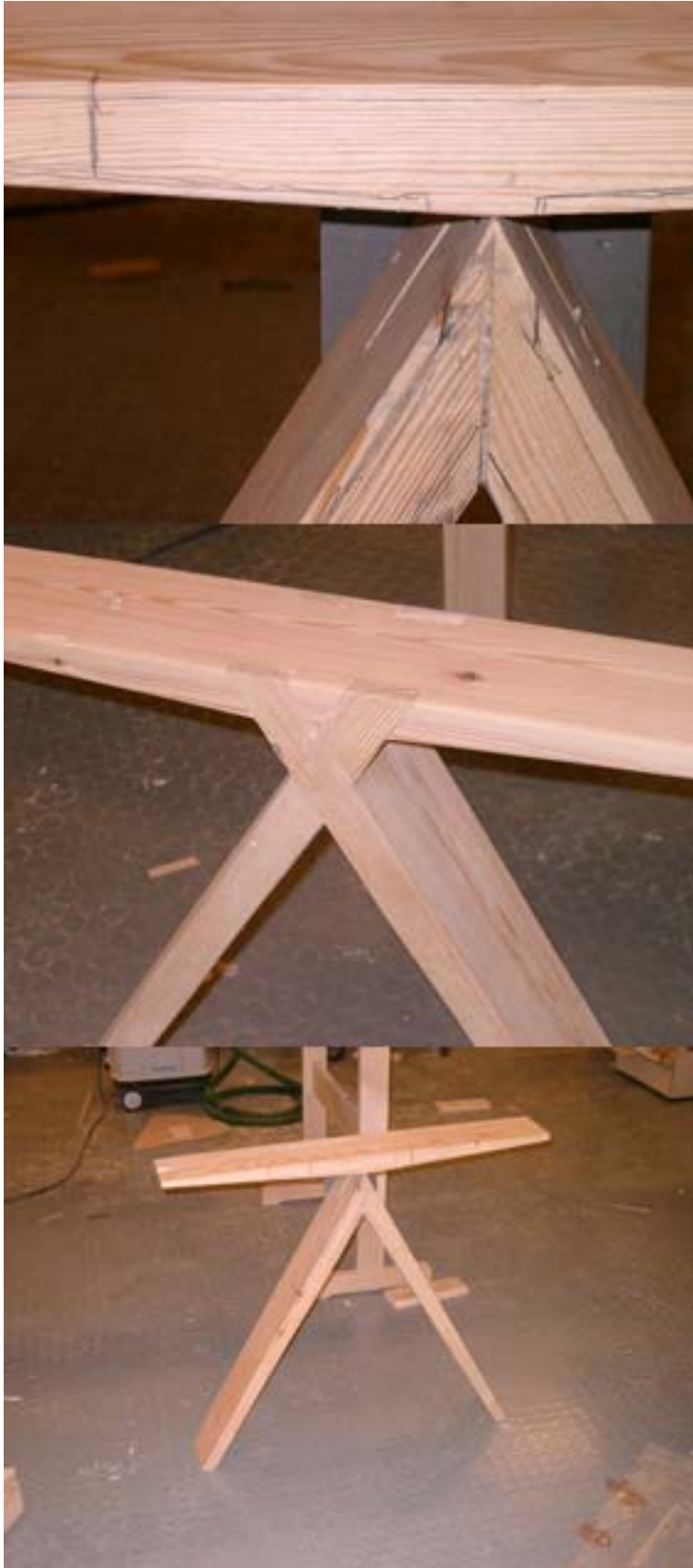
Olika försök med bock bordet, den översta och understa är med infällt stål, mitten bilden är en sink konstruktion.
